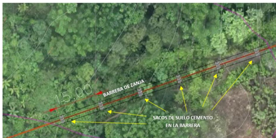
FIGURA No. 53: SEPARACIÓN DE LAS BARRERAS EN ZANJA CON LOS SACOS DE SUELO CEMENTO.
