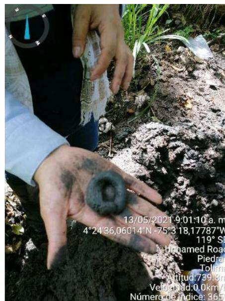
Figura 5.1-122 Medición parámetro plasticidad en campo
