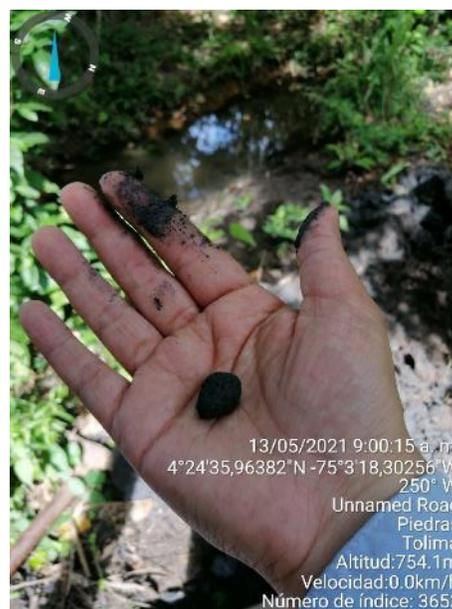
Figura 5.1-120 Medición parámetro Adherencia en campo
