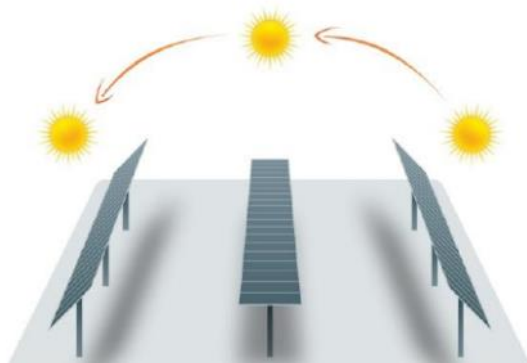
Figura 3.34 Movimiento durante el día de seguidor solar
