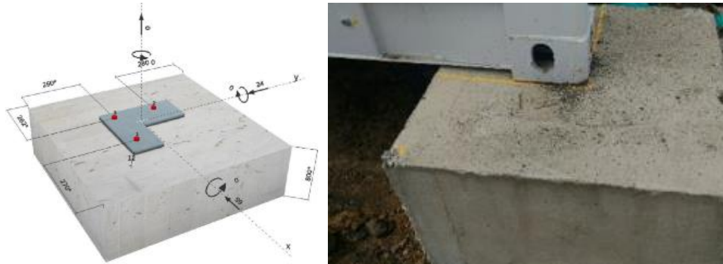
Fotografía 3.58. Imagen de cimentación de inversores y fotografía de cimentaciones.
