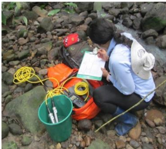
Fotografía 2.5-7 Medición de los parámetros fisicoquímicos in situ.
