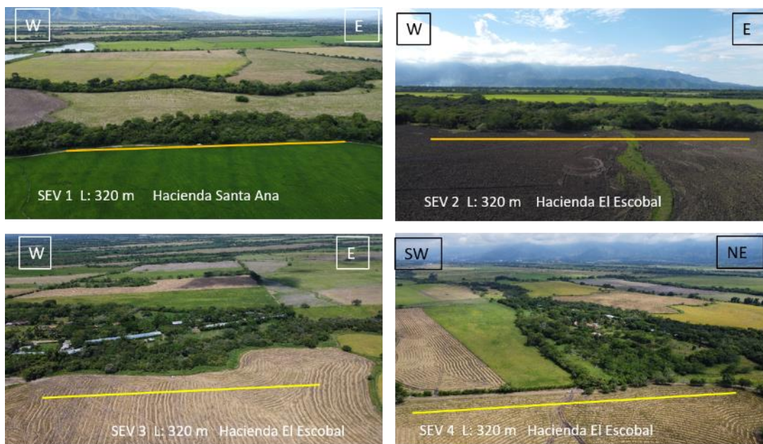
Figura 2.5-49 Características de los sondeos eléctricos verticales tomados en campo
