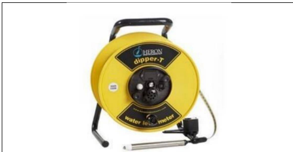
Figura 2.5-45 Sonda piezométrica de 100 metros. Fuente: MAVDT, 2005
