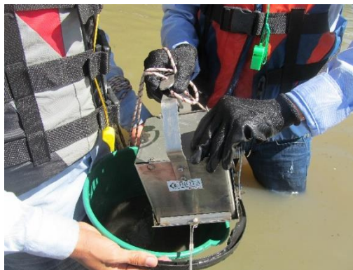
Fotografía 2.5-32 Muestreo de la comunidad de Macroinvertebrados acuáticos con Draga Tipo Ekman. Fuente: Biota Consultoría y Medio Ambiente S.A.S; 2021
