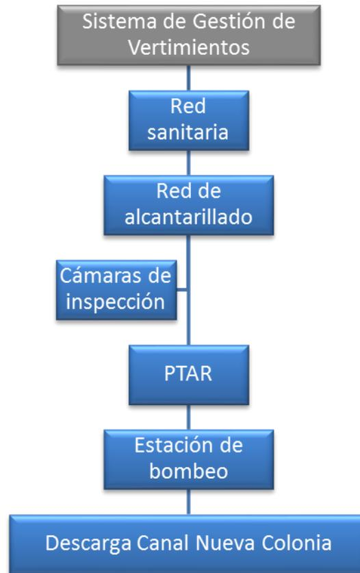
Figura 2.3. Estructuras hidráulicas del Sistema de Gestión de Vertimientos.
