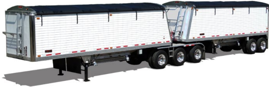
Figura No. 11.12. Vehículos especializados para el transporte de granel, tolva de alta velocidad de descargue y tándem acoplado.
