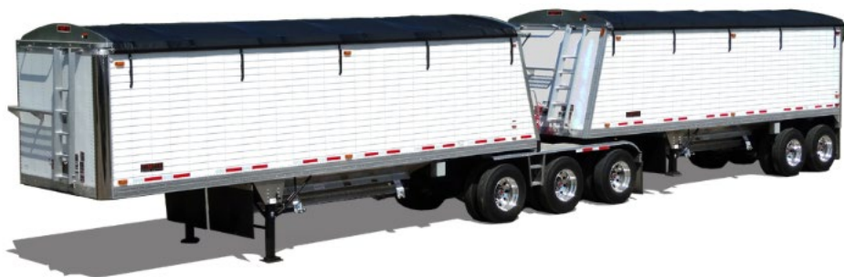
Figura No. 7.18. Vehículos especializados para el transporte de granel, tolva de alta velocidad de descargue y tándem acoplado.
