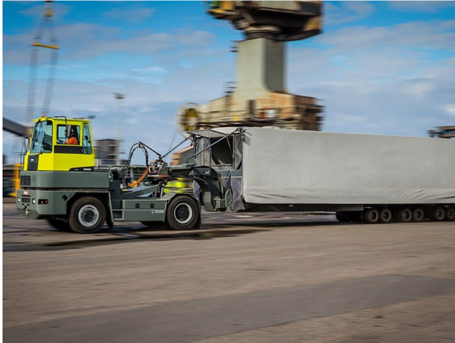
Figura No. 5.265 Equipo Kalmar TR626i / TR632i Vehículo de transporte que transitará por el viaducto.
