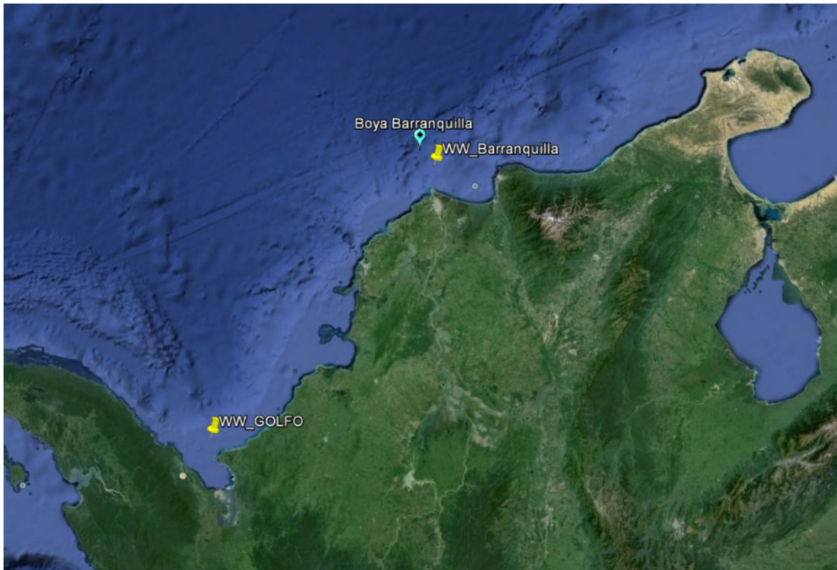
Figura No. 5.125 Sitios con información de oleaje del proyecto WaveWatchIII™. El punto WW_Barranquilla corresponden a la serie de WaveWatchIII™ que se utilizó para calibrar los datos del modelo con los datos de la boya de Barranquilla y el punto WW_GOLFO es la serie utilizada para obtener el régimen medio en profundidades indefinidas.
