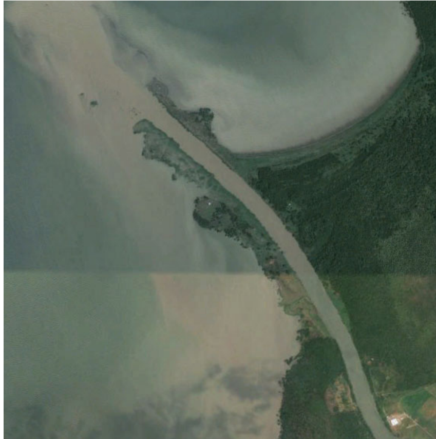
Fotografía No. 5.8 Delta del río León. Los depósitos de sedimentos se distribuyen en sentido perpendicular a la costa. Fuente: Imagen Google Earth nov 1-2014.
