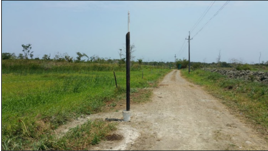
Fotografía No. 5.27 Piezómetro instalado en tierra. Fuente: EDIFICA COLOMBIA LTDA, en PIO S.A.S, 2015 180
