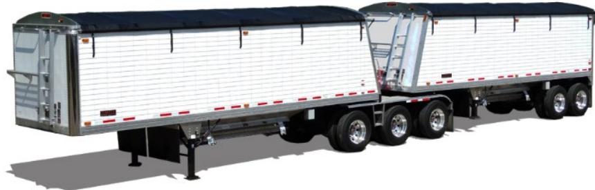
Figura No. 3.37. Vehículos especializados para el transporte de granel, tolva de alta velocidad de descargue y tándem acoplado.
