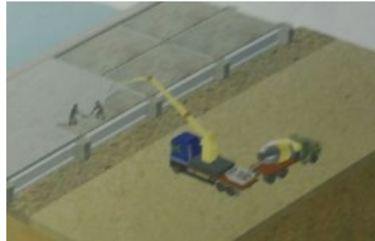
h. Vaciado de losa superior
