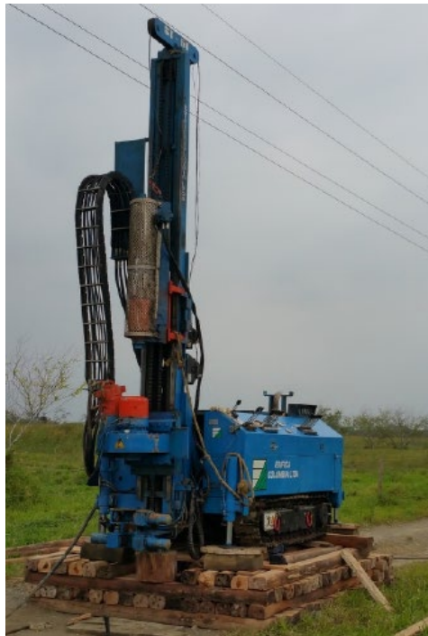
Fotografía No. 2.2 Equipos para la exploración del subsuelo en tierra Fuente: EDIFICA, 2015
