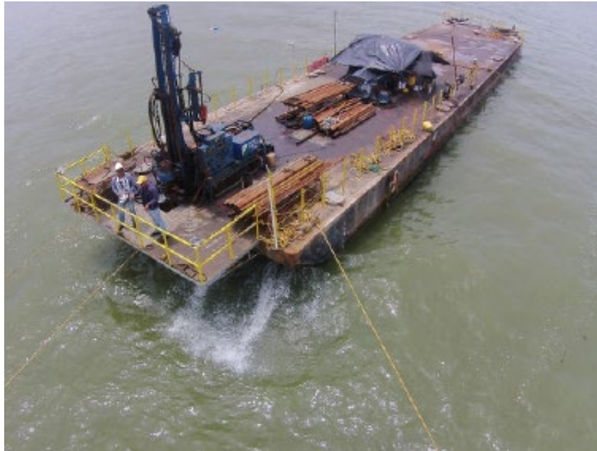
Fotografía No. 2.1 Equipos para la exploración del subsuelo en agua Fuente: EDIFICA, 2015
