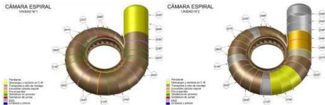
Figura 38: Progreso de las cajas en espiral de la unidad 1 [casi terminadas] y de la unidad 2 [muy avanzadas]
