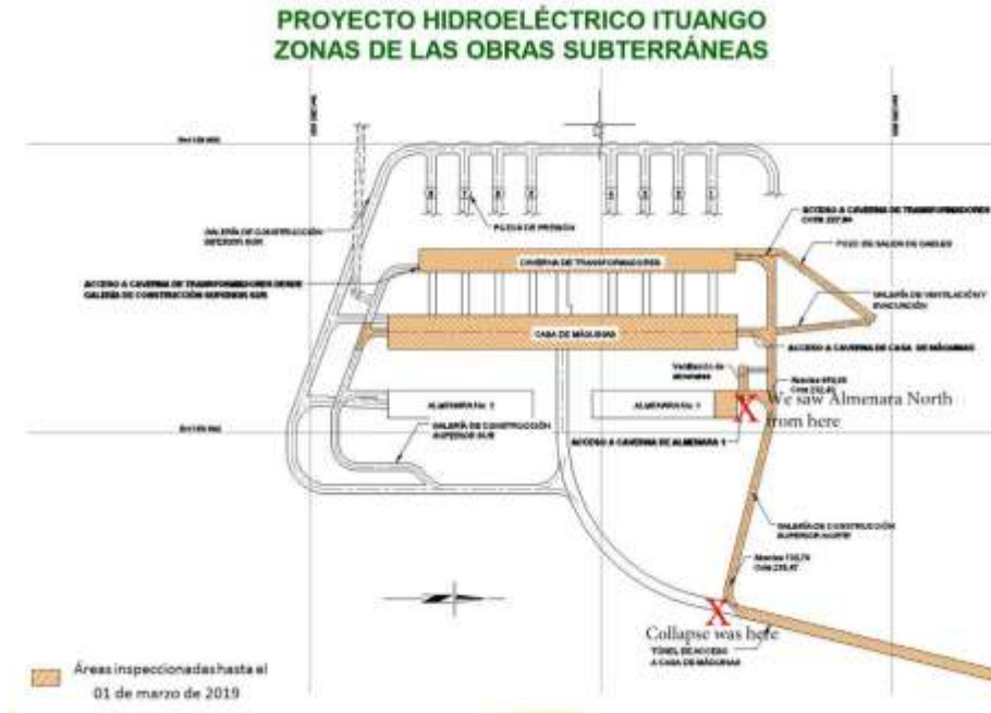
Figura n.º 1: Accesos al complejo de cavernas, 5 de marzo.
