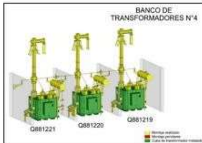
Figura n.º 11: Avances en la instalación al momento de la inundación de la sala de máquinas norte
