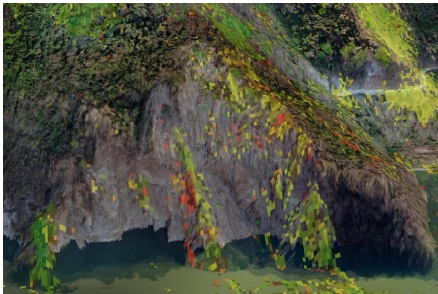
Figura 35: La pendiente del lado derecho corriente arriba. Examen satelital. Los puntos rojos se corresponden con desplazamientos.
