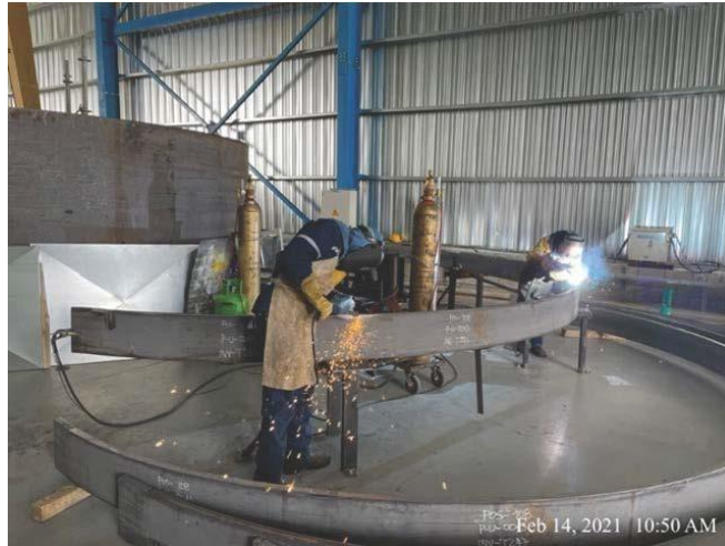
Figura 56: Codo inferior, fabricación de elementos de revestimiento de acero
