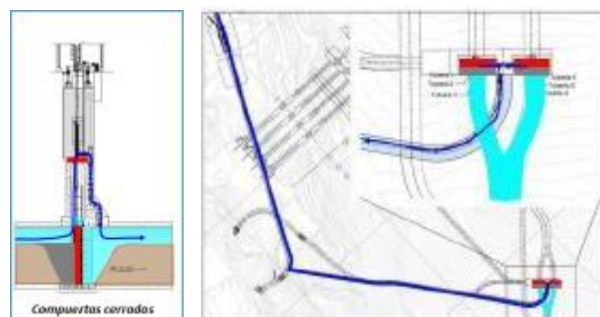
Figura 60: Compuertas de GAD en su posición final con sistema de derivación directa temporal (izquierda) y a través de la IDG (derecha)
