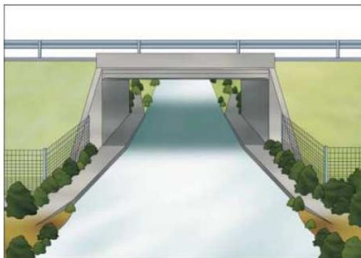
Esquema general de un drenaje adaptado para paso de mamíferos y peces
