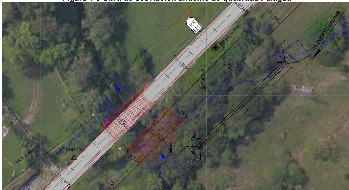
Figura 4-8 Obra de desviación afluente de quebrada Palagua
