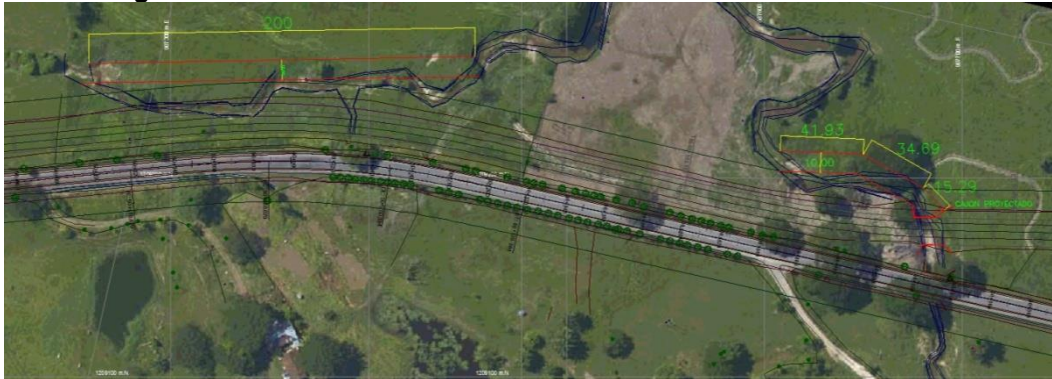
Figura 4-11 Rectificación del cauce entre el PR50+000 al PR50+530
