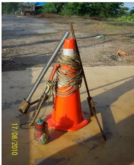
**Fotografía 1-10 Elementos básicos utilizados en la labor de inventario al cien por ciento en el corredor del derecho de vía: cono para seguridad vial, ya que la labor se realiza desde borde de vía; cuerda para demarcar las franjas de ubicación de los árboles; machete para el acceso hasta el árbol y elemento de limpieza de la superficie de corteza para su marcado; forcípula para la medición de diámetros; pote o frasco para el marcado de árboles con pintura de aceite**
