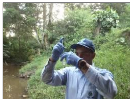
Fotografía 1-3 Muestreo fisicoquímico y bacteriológico. Medición de parámetros in situ
