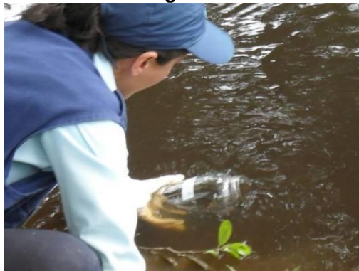
Fotografía 1-1 Toma de muestras para análisis fisicoquímico.
