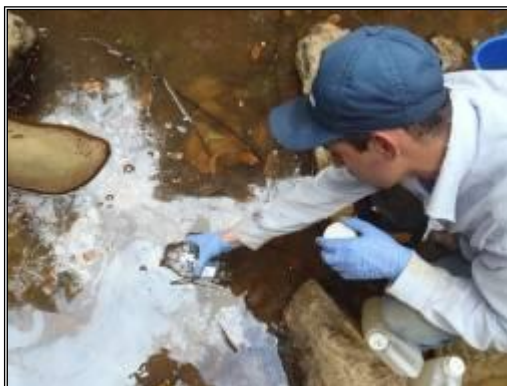
Fotografía 1-2 Toma de muestras para análisis de coliformes y de grasas y aceites.
