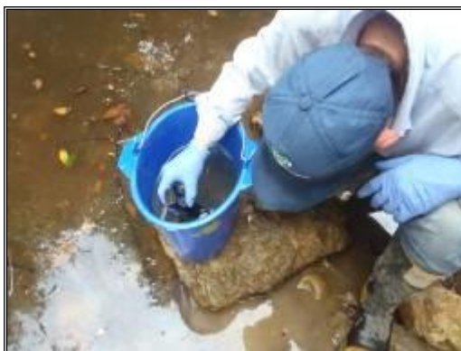
Fotografía 1-3 Muestreo fisicoquímico y bacteriológico. Medición de parámetros in situ
