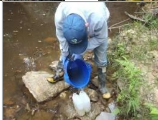
Fotografía 1-1 Toma de muestras para análisis fisicoquímico.
