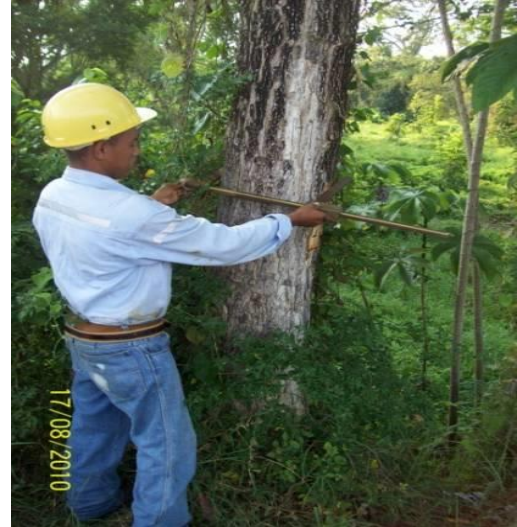
Fotografía 1-8 Modo de ajuste del diámetro del árbol a la abertura de la forcípula.
