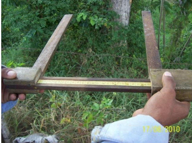
Fotografía 1-7 Detalle de orientación de la forcípula para la medición de diámetros; objeto y método que disminuye las probabilidades de error de medición de diámetros en los árboles.
