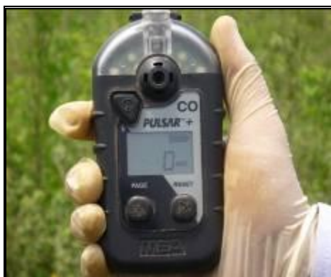
Fotografía 3-48 Equipo utilizado para las mediciones de CO.
