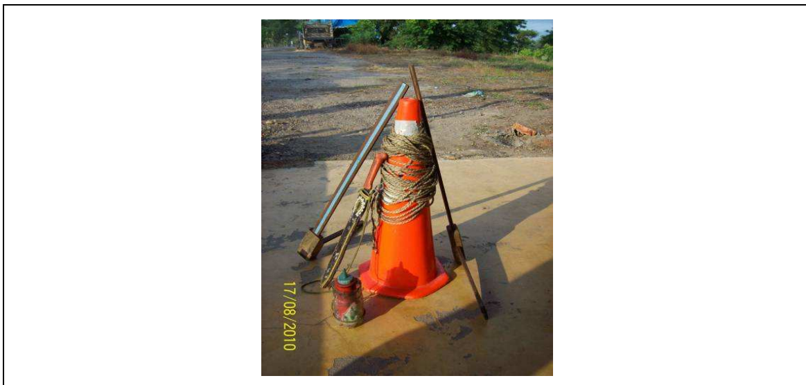
Fotografía 1-6 Elementos básicos utilizados en la labor de inventario al cien por ciento en el corredor del derecho de vía: cono para seguridad vial, ya que la labor se realiza desde borde de vía; cuerda para demarcar las franjas de ubicación de los árboles; machete para el acceso hasta el árbol y elemento de limpieza de la superficie de corteza para su marcado; forcípula para la medición de diámetros; pote o frasco para el marcado de árboles con pintura de aceite
