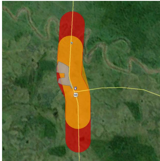
Ilustración 5.4.5-5: Buffer de 250 m alrededor del paso vial actual (rojo) y de la variante (naranja).
