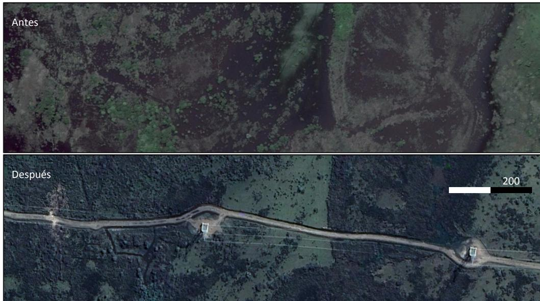
**Figura 4-4:** Imágenes satelitales antes y después de la construcción de la LAT Melo-Tacuarembó (construcción iniciada en 2018), en los bañados asociados al río Tacuarembó. Se observa la conformación de canales de drenaje a ambos lados de la caminería y a través de los bañados.
