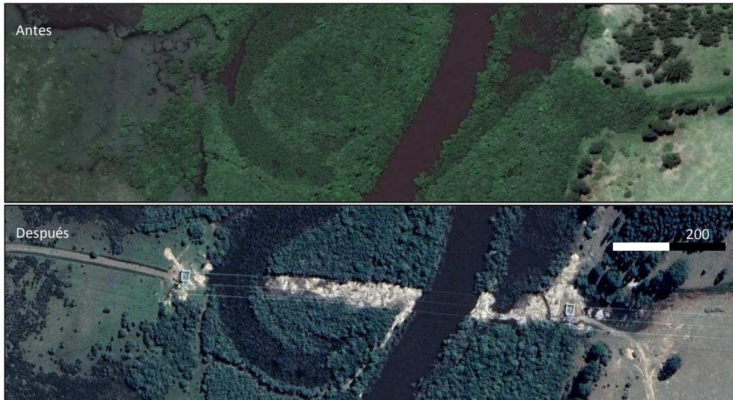
**Figura 4-2:** Imágenes satelitales antes y después de la construcción de la LAT Melo-Tacuarembó (construcción iniciada en 2018), en el bosque ribereño del río Tacuarembó. Se observa el desbroce de una faja de 30 m de ancho.
