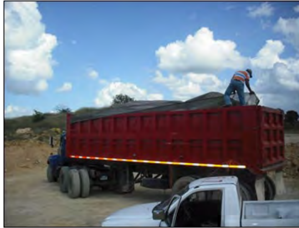
Foto 6.2.1-2. Vista de trabajador cubriendo la carga de un camión con una lona.
