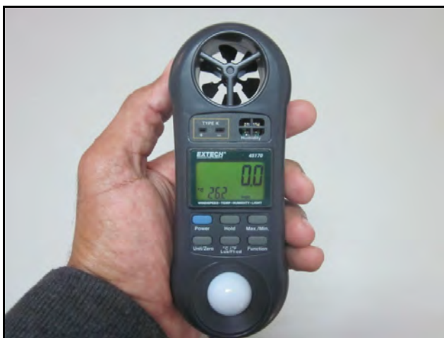
Foto 6.6.2.3-1. Estación meteorológica Extech 45170.
