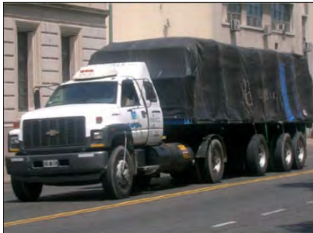
Foto 6.2.1-3. Vista de una carga debidamente cubierta con lona.
