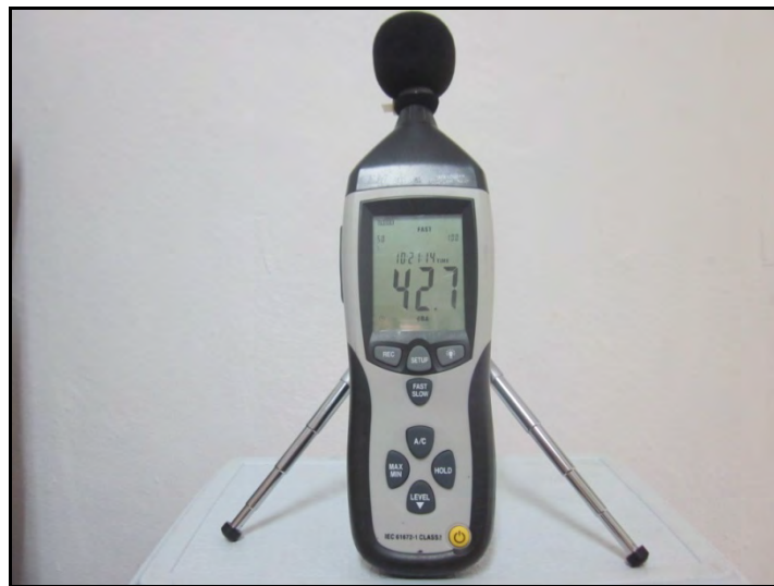
Foto 6.6.2.3-4. Sonómetro marca CEM DT-9952 (IEC-61672-1 CLASS 2).
