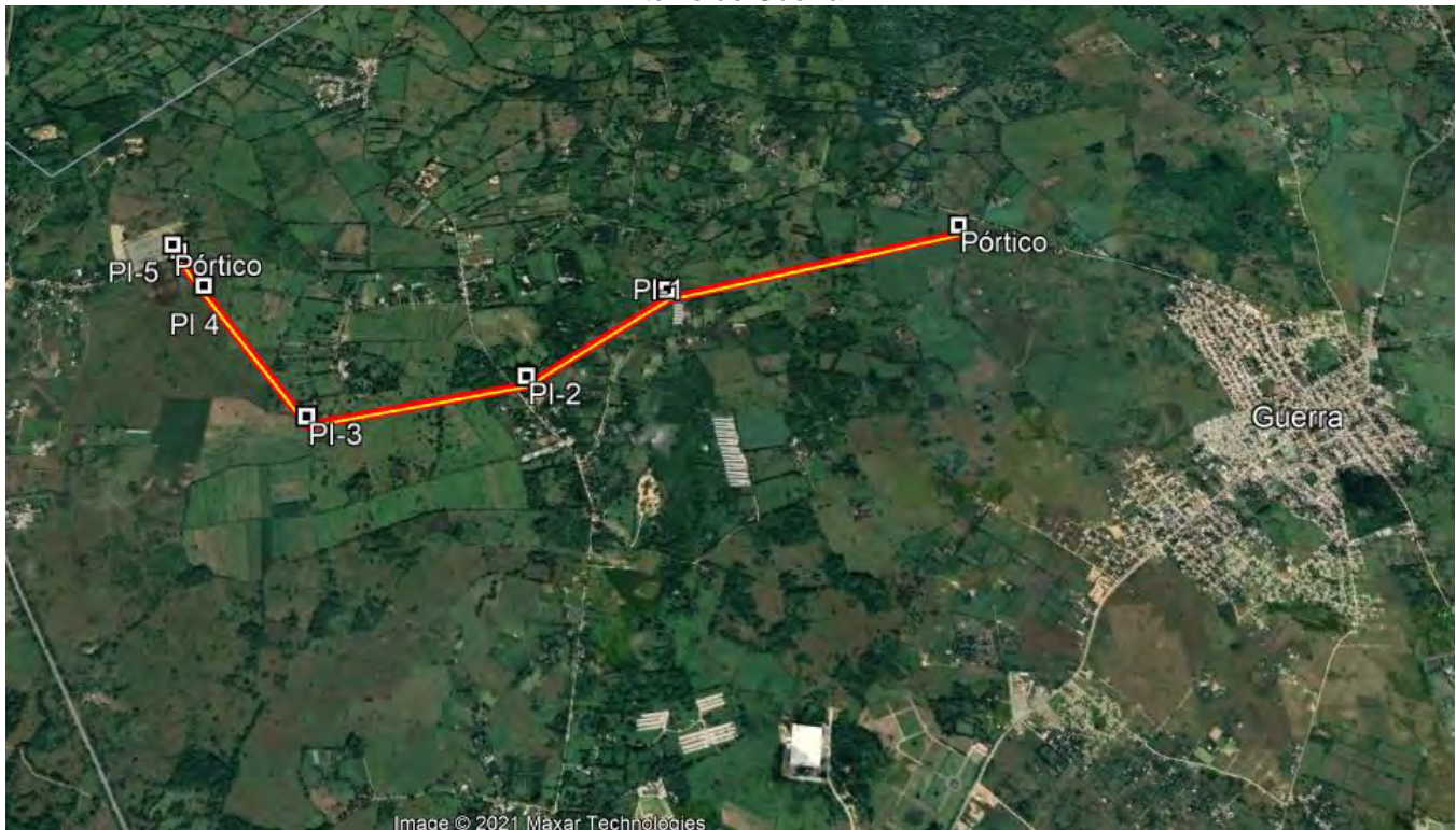
Figura 2. Línea de alta tensión de 138 kV que conectará el Parque Solar Mirasol con la subestación de San Antonio de Guerra.
