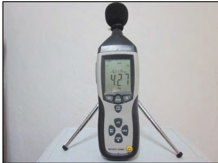
Foto 6.6.2.3-4. Sonómetro marca CEM DT-9952 (IEC-61672-1 CLASS 2).
