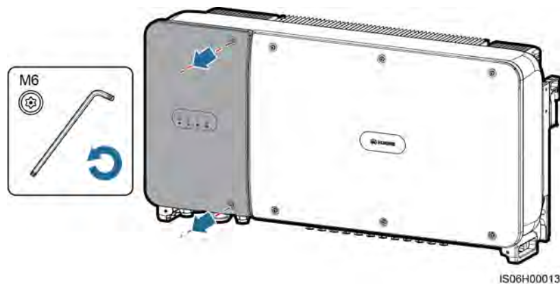
Figura 5-2 Desajuste de tornillos
