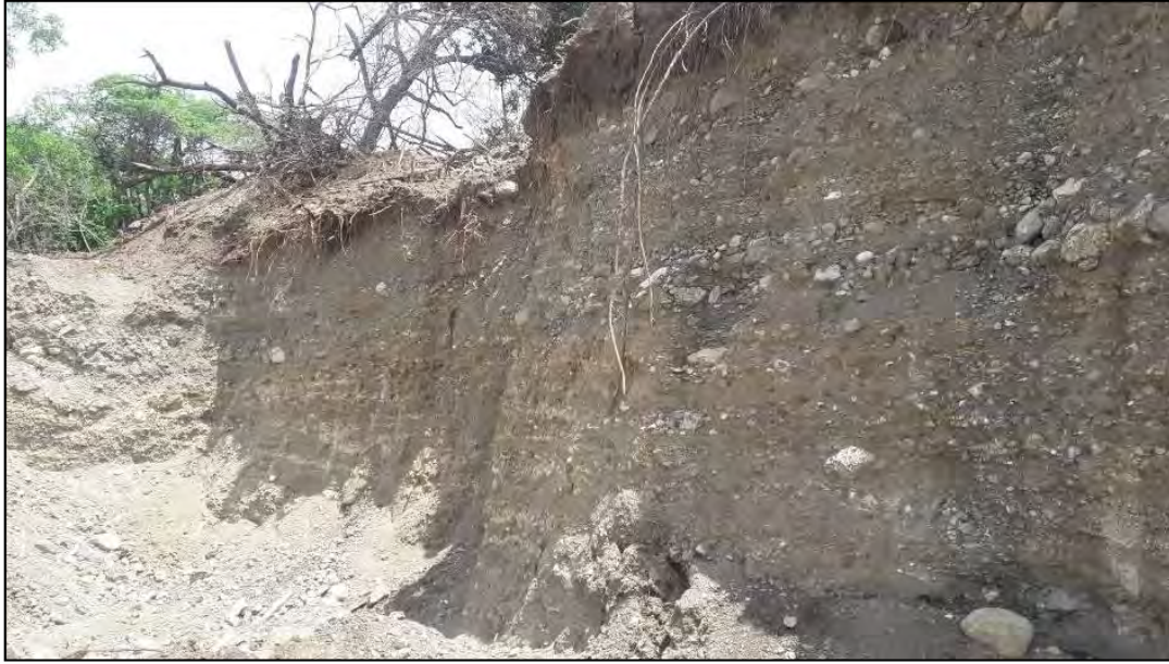
Foto 2.3.2-1. Capas de meteorización representadas por sedimentos arenosos y arcillosos en la zona de estudio.
