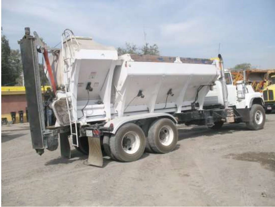
Foto 2. 1 Modelo de camión dosificador que se empleará para preparar el concreto
