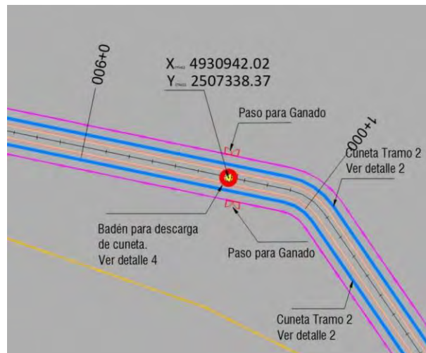
Figura 87 Badén de descarga
