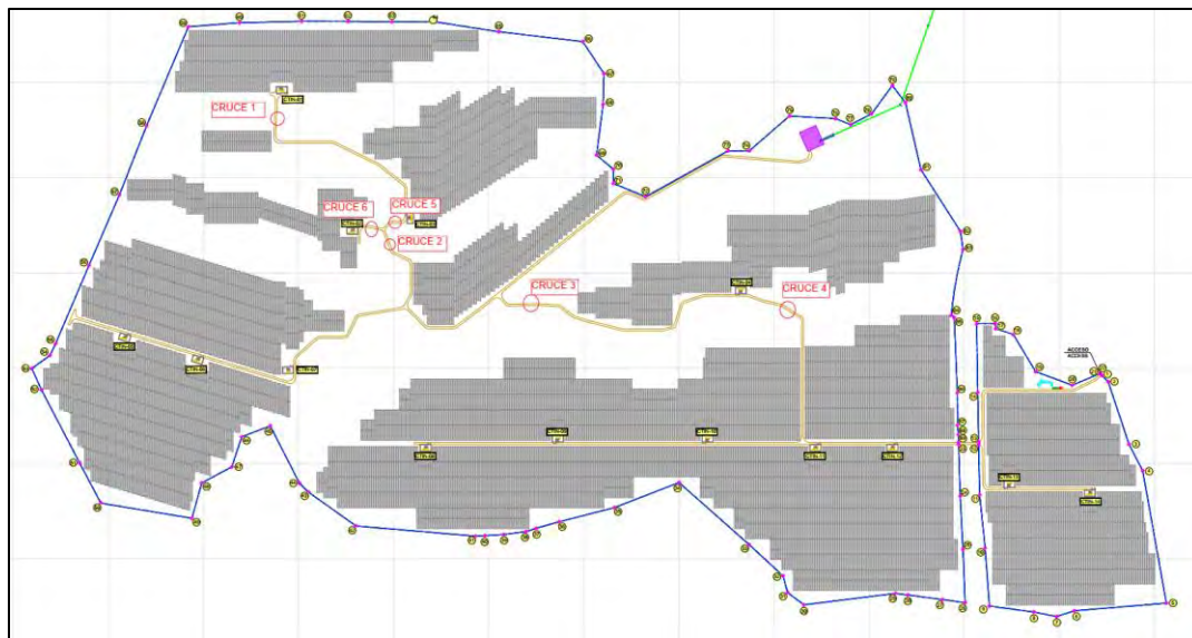
Figura 54 Localización de los cruzamientos al suroeste de la PFV
