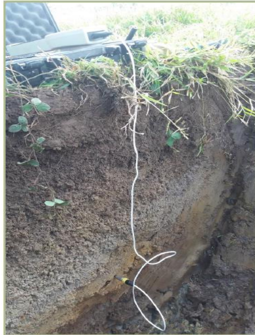
Figura 5. Medición de resistividad térmica en el terreno.
