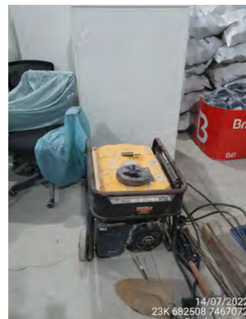
Foto 06: Detalhe do gerador sem a presença da bacia de contenção dentro do galpão do programa Vem Com a Gente..
