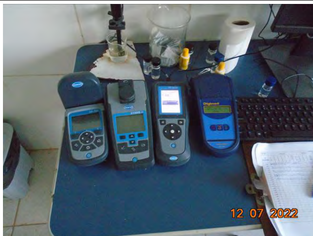
Foto 15: Detalhe dos aparelhos utilizados na medição dos parâmetros da água tratada/bruta.
