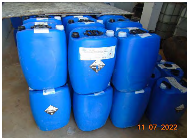
Foto 07: Área de armazenamento do sulfato de alumínio ferroso utilizado na etapa de floculação.
