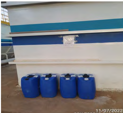
Foto 05: Vista de produtos químicos dispostos de forma irregular, sem contenção, sem extintor.
