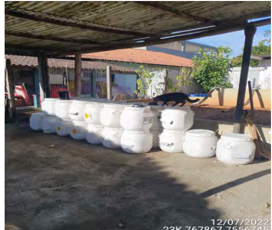
Foto 14: Vista dos produtos químicos dispostos de forma irregular, sem bacia de contenção, sem sinalização e sem extintor na área. Nota-se a presença de uma escola do lado esquerdo.
