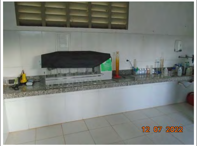
Foto 14: Detalhe do aparelho para realização do teste de floculação (Jar Test) no laboratório da ETA Caceribú.
