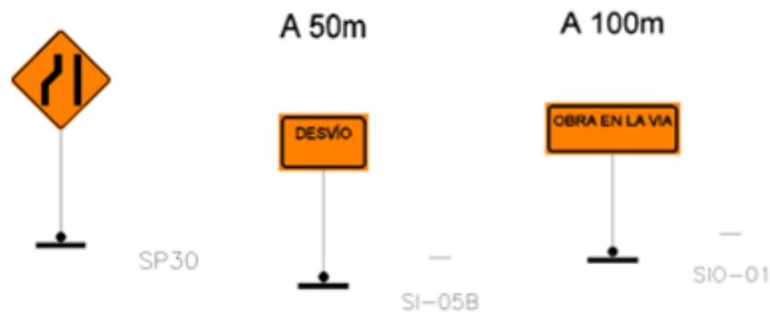
A continuación se presentan los esquemas de señalización típicos, previstos en el Capítulo 9 del Manual de Señalización Vial de 2015, para la Señalización temporal – Reparaciones temporales urbanas o rurales (Figura 9.11) y Señalización temporal-Obstáculo y/o peligros en la vía (figuras 9.12 y 9.13).
