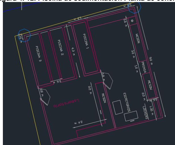
Figura 4. 12. Piscina de sedimentación Planta de concreto
