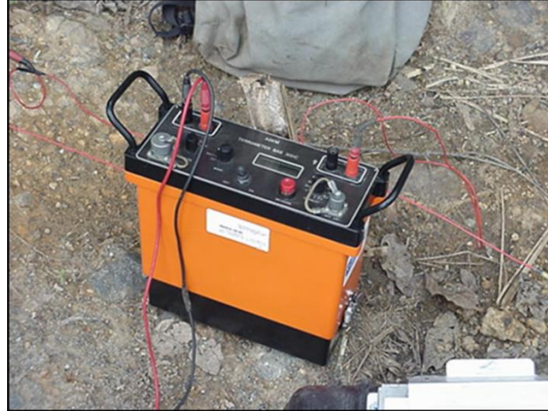
Figura 5. 42 Equipo de exploración Geoeléctrica ABEM SAS 300-C
