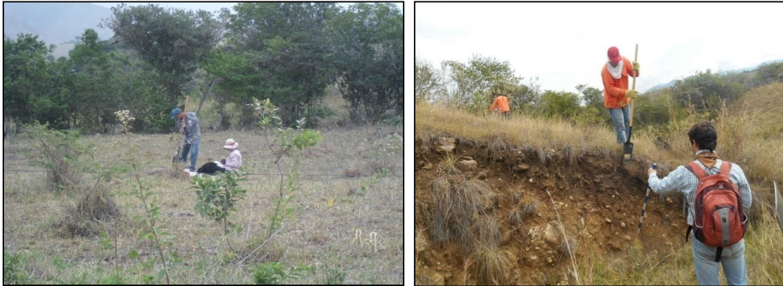
Figura 5. 213 Realización de pozos de sondeo y perfiles estratigráficos durante la prospección
