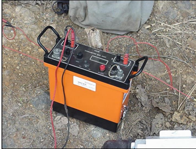
Figura 5-52 Equipo de exploración Geoeléctrica ABEM SAS 300-C
