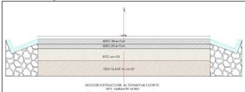
Figura 3-44: Sección Estructura Alternativa 3 – Corte
