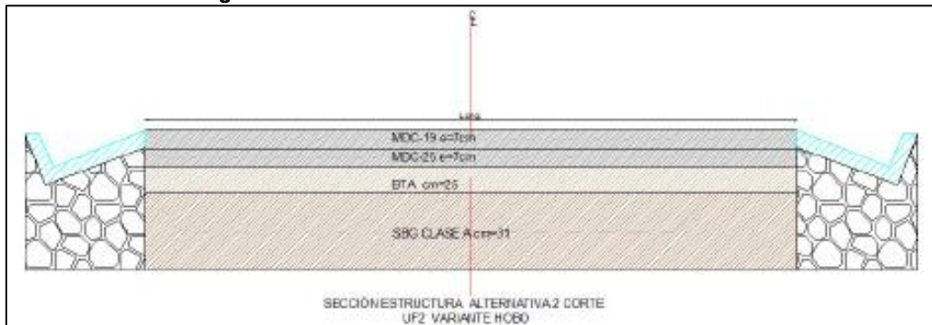
Figura 3-42: Sección Estructura Alternativa 2 – Corte
