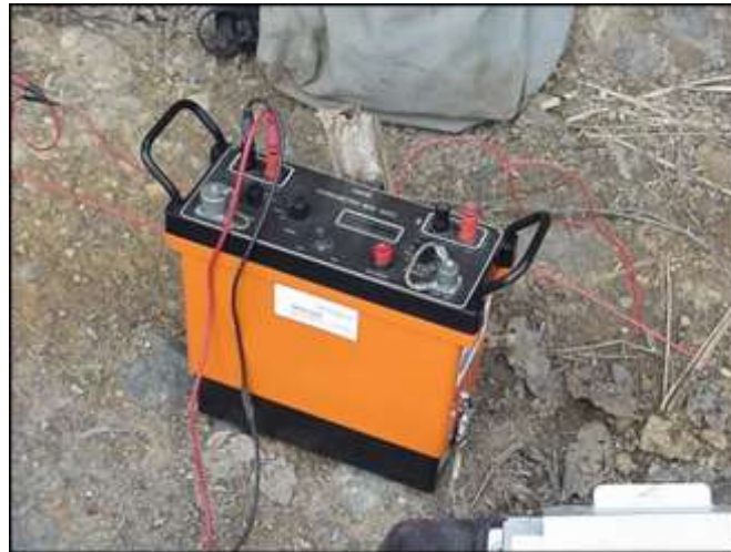
Figura 5-101. Equipo de exploración Geoeléctrica ABEM SAS 300-C
