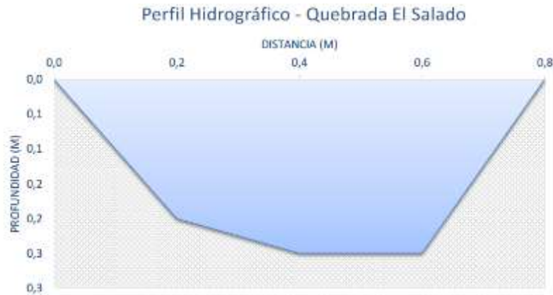
Figura 5-96 Perfil Hidrográfico Quebrada El Salado. Unidad Funcional 1: Neiva - Campoalegre
