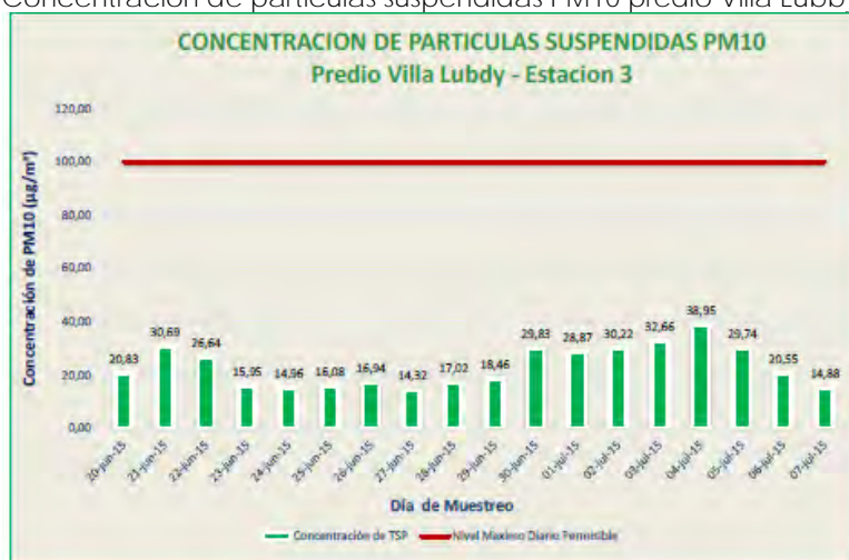
Figura 72. Concentración de partículas suspendidas PM10 predio Villa Lubdy-estación 3
