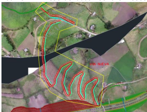
Fotografía 3.125 Tramo de vía inicial a construir y tramo de vía existente a adecuar para el acceso a la Zodme Z2-1B. Coordenadas E 952619 N 595507
