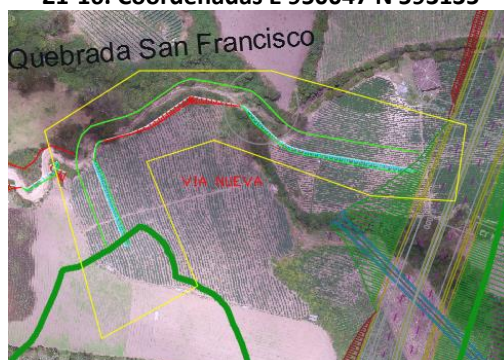
Fotografía 3.118 Vista en planta del acceso a la Zodme Z1-16. Coordenadas E 950047 N 593135
