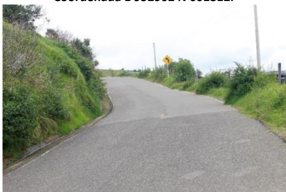
Fotografía 3.19 PK7+732. Cambio en las características de la vía. Pavimento flexible, con calzada de hasta 6.0 m de ancho, carece de señalización horizontal. Coordenada E 952902 N 601812.
