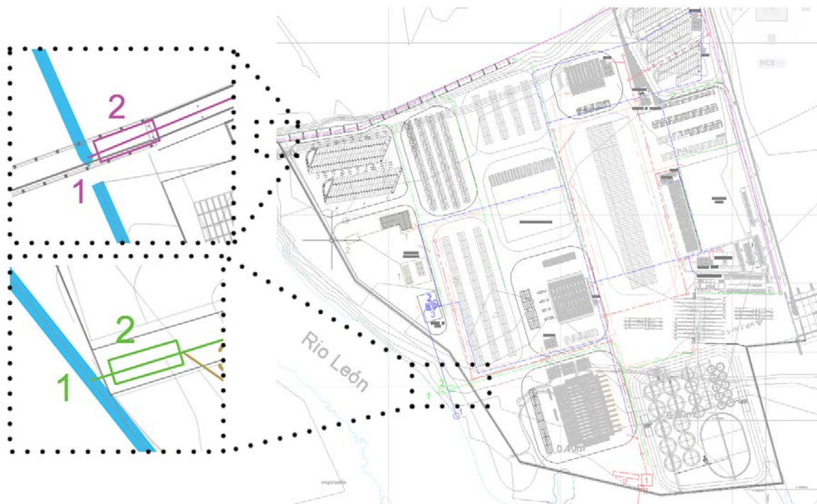
Figura 10. Ubicación de infraestructuras para aguas lluvias [color verde]. Tratamiento y descarga aguas lluvias canal [color morado]. Tratamiento y descarga aguas lluvias alcantarillado en los dos casos con el número 2: desarenador, y número 1: descarga
