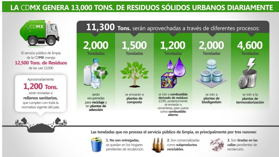
Figura II—16. Propuesta del Gobierno de la Ciudad de México para el aprovechamiento de los Residuos Sólidos Urbanos.
