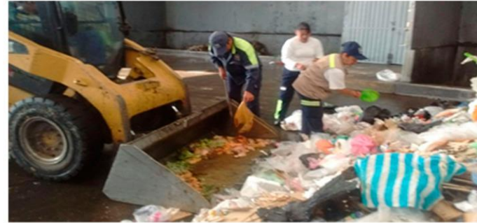
Se retiran los residuos orgánicos y los inorgánicos se tiran a la caja de transferencia
