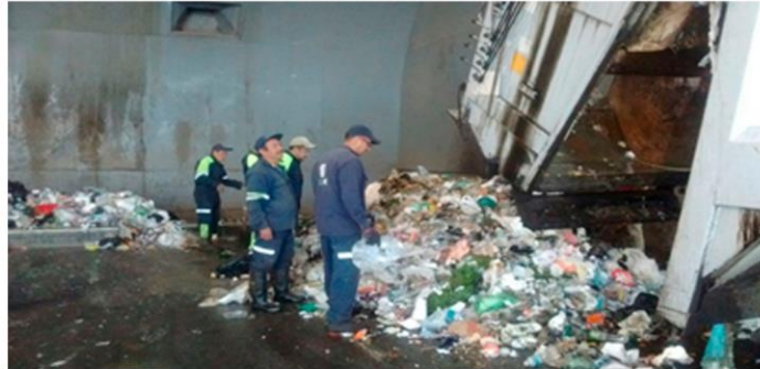
Se verifica que los residuos no se encuentren mezclados y que no contengan residuos de la construcción o de manejo especial
