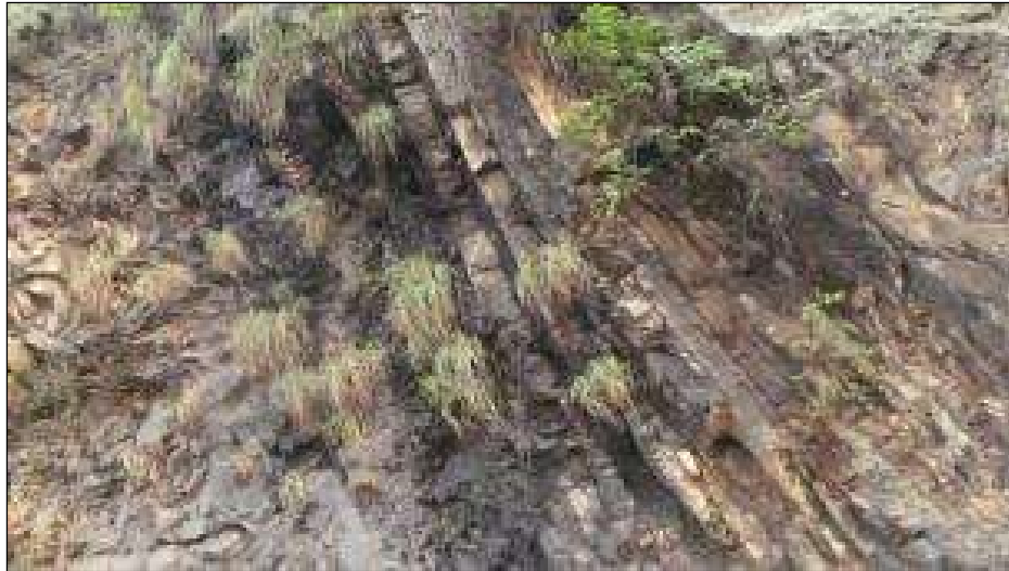
Fotografía 22 Túnel Divino Niño. Niveles de areniscas y liditas fracturadas con alto buzamiento al Norte.
