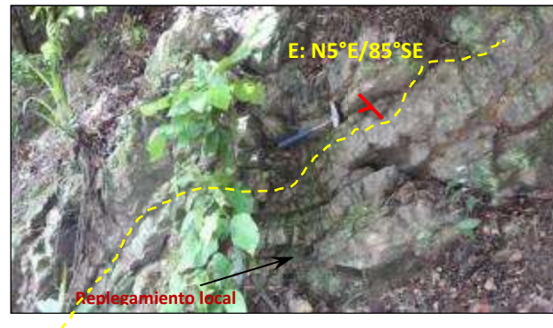
Fotografía 16 Zona de portal entrada Túnel Ermitaño. Se observa la secuencia de areniscas amarillas y niveles de liditas, localmente plegadas.
