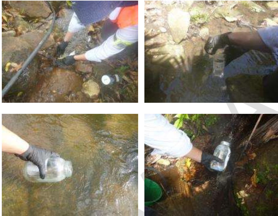
Fotografía 67 Toma de muestra de coliformes y grasas y aceites.
