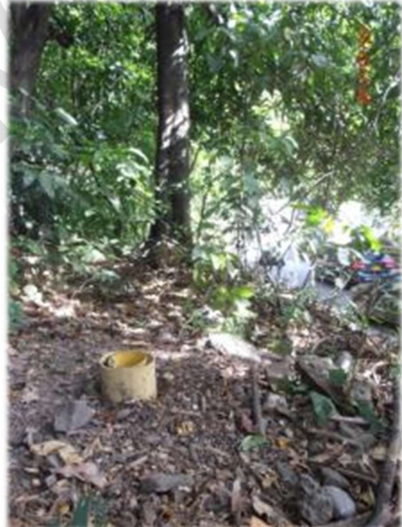
Fotografía 55 Prueba de infiltración en PS-2 Coordenadas E: 933.251, N: 957.306; altitud: 292 m
