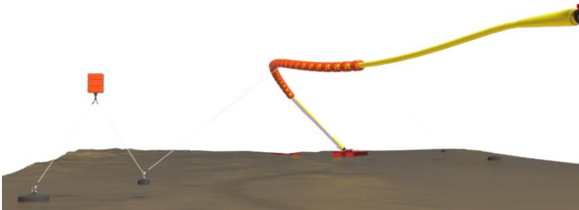
Figura 1-11 - Configuración de tubería elevadora 3D
