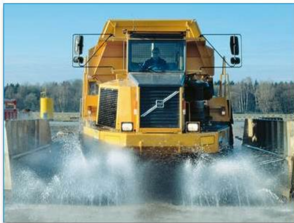
Fotografía 3-1 – Imagen del sistema de lavado de llantas
