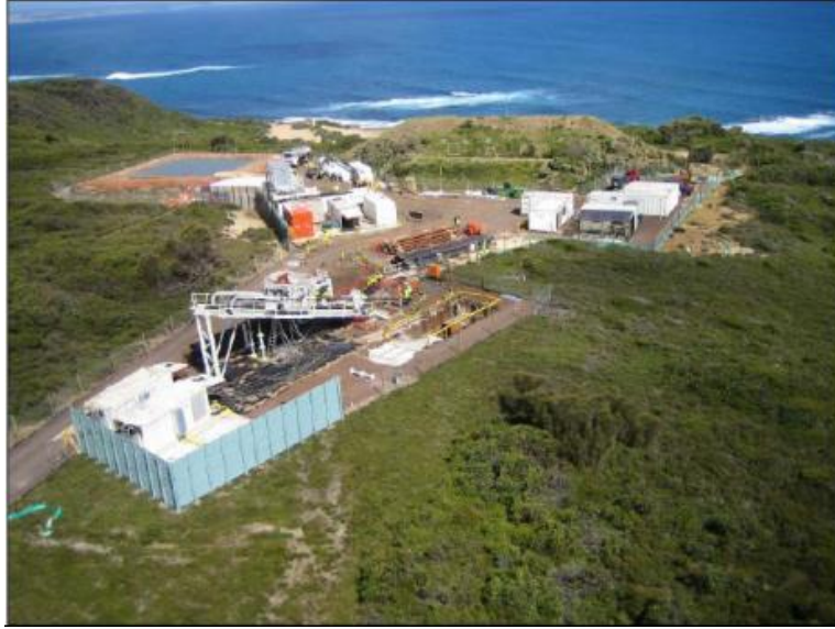
Figura 1-27 - Distribución en sitio del sistema HDD – Proyecto de Gas en Otway
