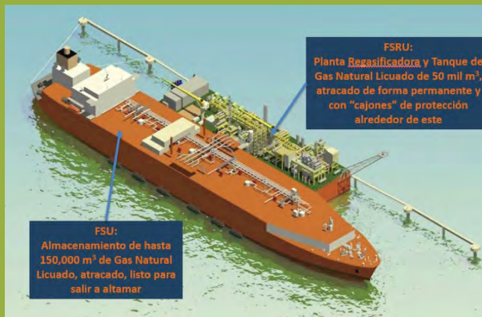
FSU/FSRU con cajones de protección
