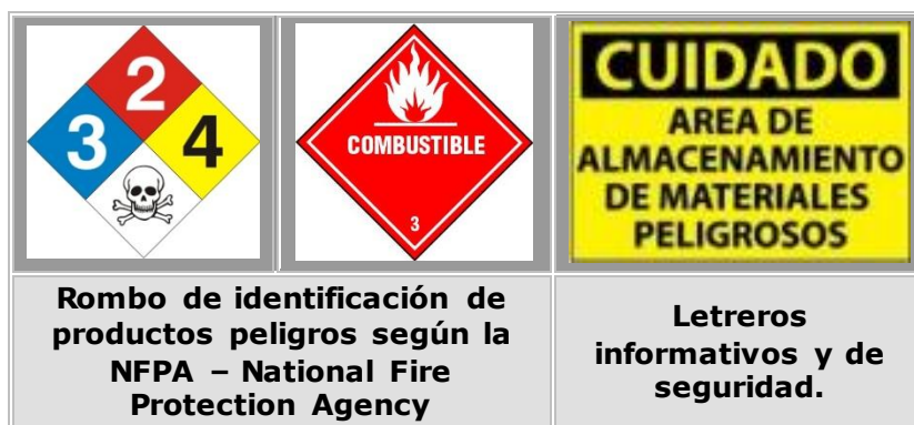
Figura 7-5. SENALETICA DE SEGURIDAD EN EL ALMACENAMIENTO PRODUCTOS PELIGROSOS
