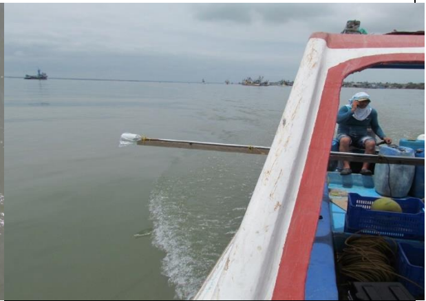
Fotografía 8: Montaje del sensor magnetométrico en el bote
