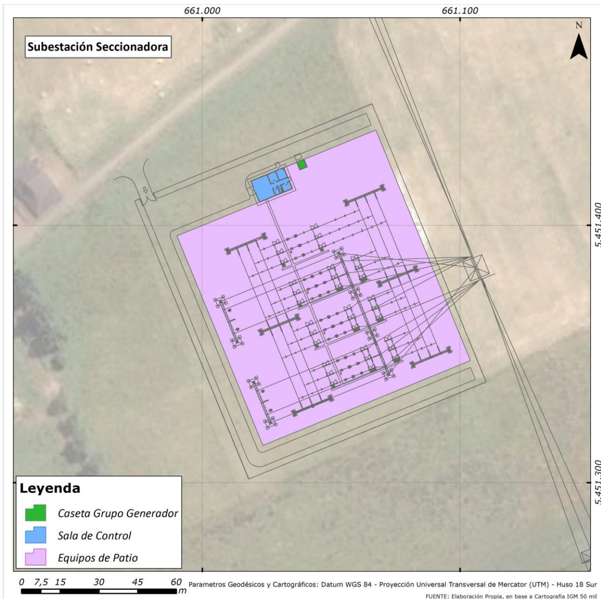
Figura 17. Distribución de equipos y componentes Subestación Seccionadora Puelche Sur 220 kV.
