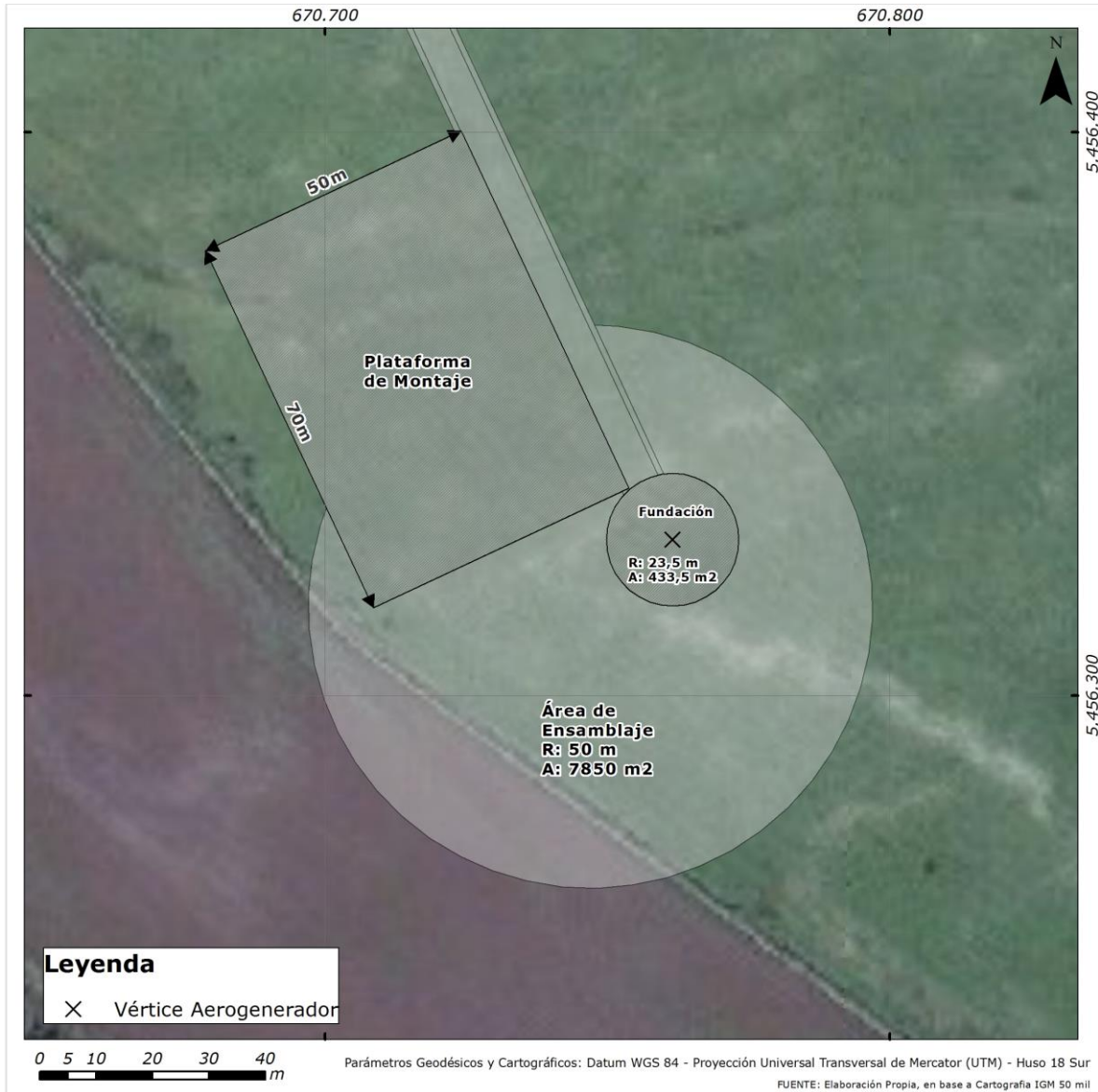
Figura 6. Esquema referencial de la disposición de la fundación, plataforma de montaje y área de ensamblaje de aspas de un aerogenerador
