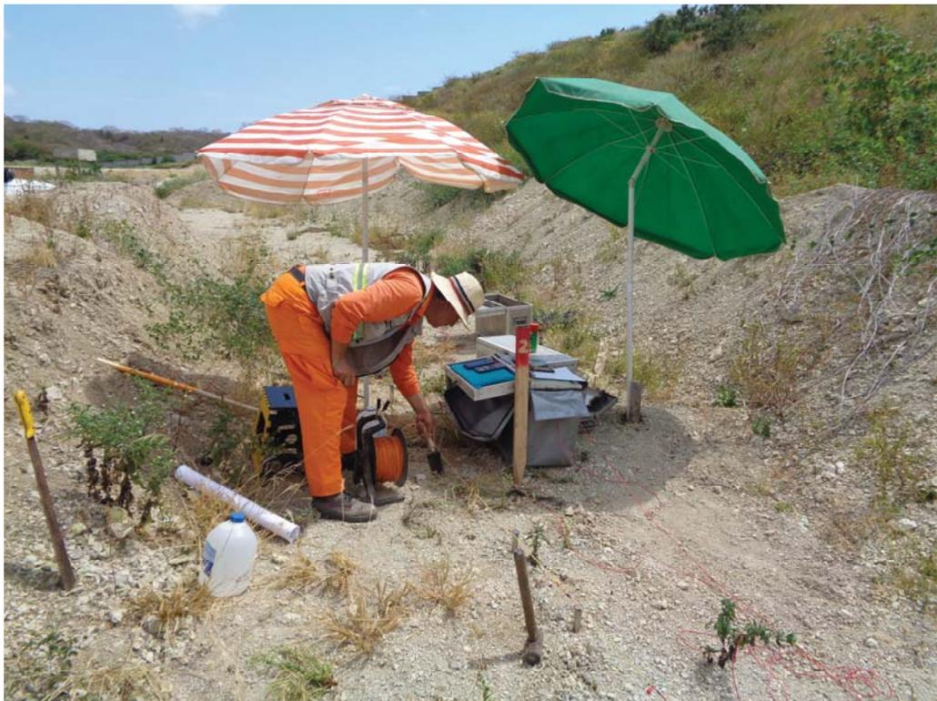
**Foto 2.-** Sondeo Eléctrico Vertical SEV-2
