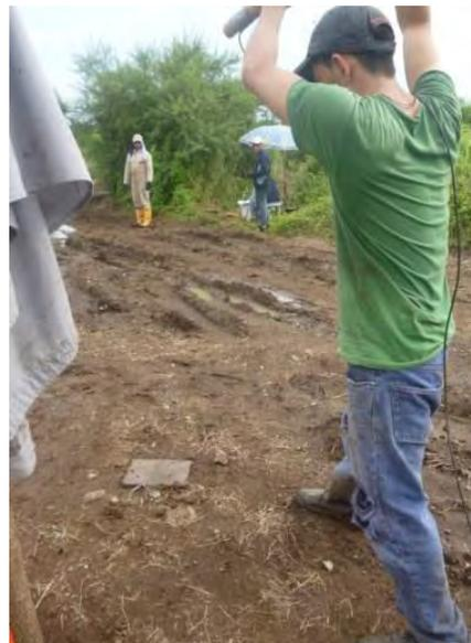
Figura 11 La realización de la prueba de MASW. Note la placa de acero utilizada como fuente de impacto de las ondas del suelo cuando sea este golpeado por el suelo.
