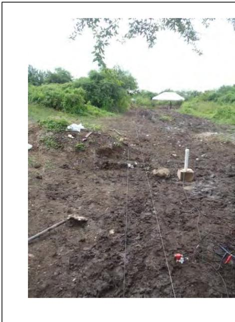
Figura 10 Arreglos de los Geófonos de MASW (Recibidores de fuentes) en el sitio cerca del pozo R03.
