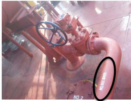
Cuando la presión es demasiado alta, se expulsa Nitrógeno por el palo de venteo.
