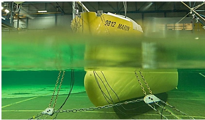
Figura 7 Combinado bajo / por encima del agua de la prueba con el FSRU mostrando el restrictor de proa
