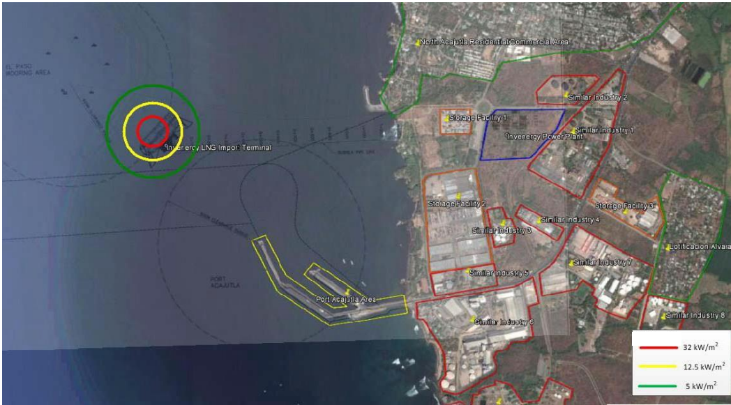
Figura 7.3: Pool fire - distancias de riesgo de una liberación de GNL de tanques de almacenamiento GNLC o FSU.
