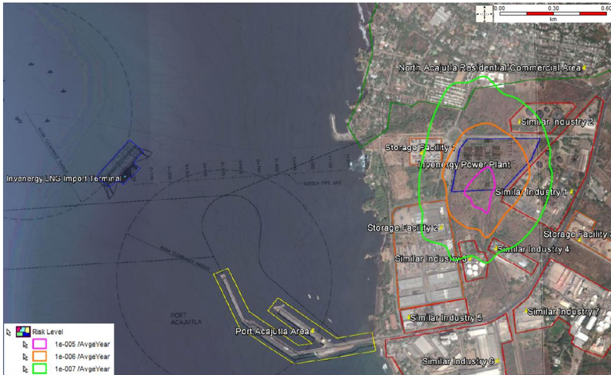
Figura 8.5: Contornos en tierra LSIR iso-riesgos - Volumen de tubería reducido con válvula de aislamiento adicional en la vecindad de la opción de la línea de costa.
