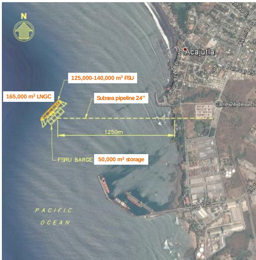
Figura 3.2: Instalación de la terminal de importación GNL.
