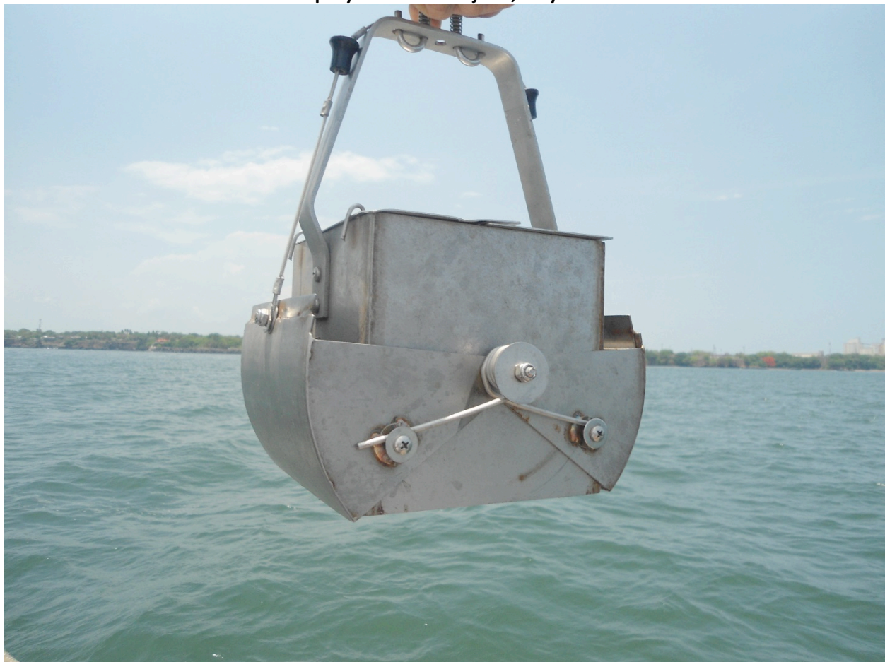
Figura 3.1 Dragas utilizada para la extracción de sedimento del lecho marino del sitio de disposición final del proyecto EDP. Acajutla, mayo de 2017.
