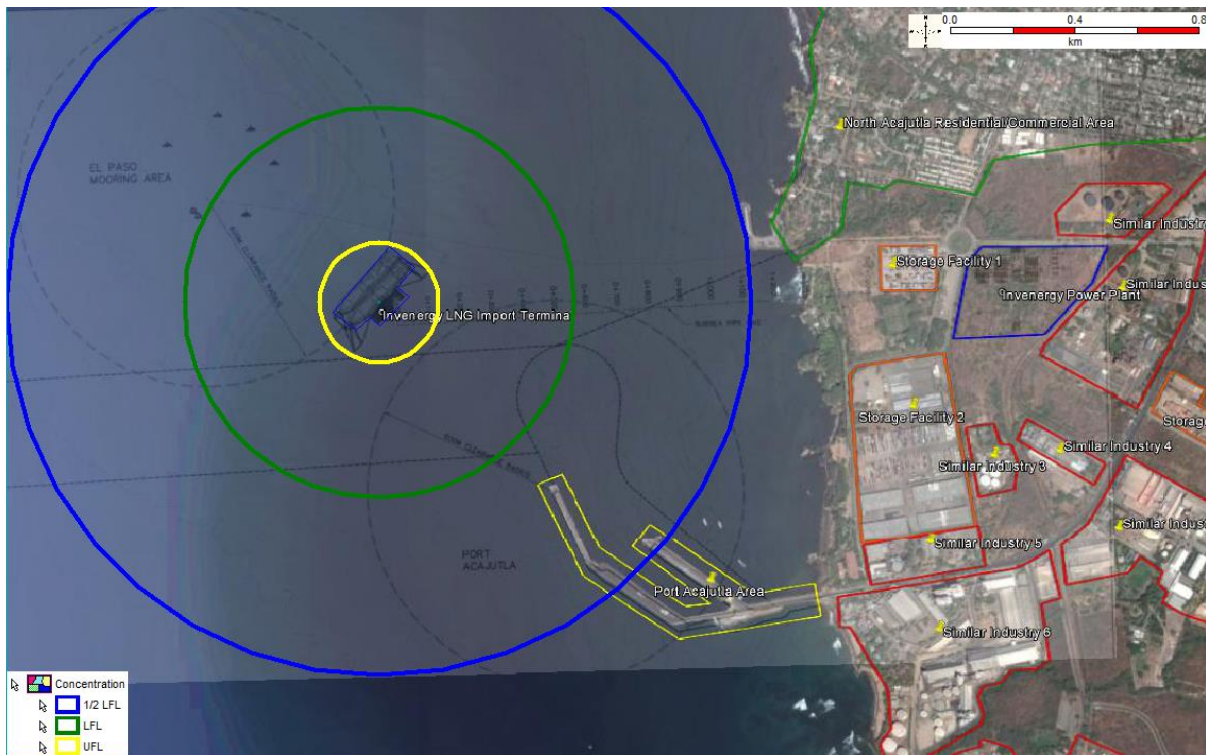
Figura 7.1: Dispersión de gas de una ruptura del brazo de transferencia GNL de la FSU.
