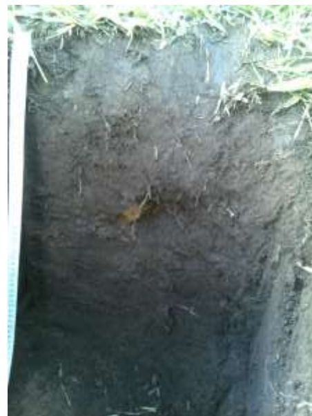
Fotografía 3.46 Unidad LQCd. Suelo Typic Dystrudepts, franca fina, isotérmica (Calicata HMV 4 Coordenada Magna Bogotá E:1079559 - N:1185926)
