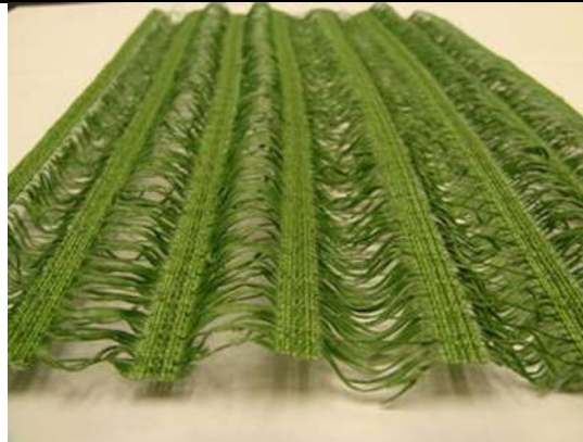
Figura 7.4 Biomanto para el control de escorrentía
