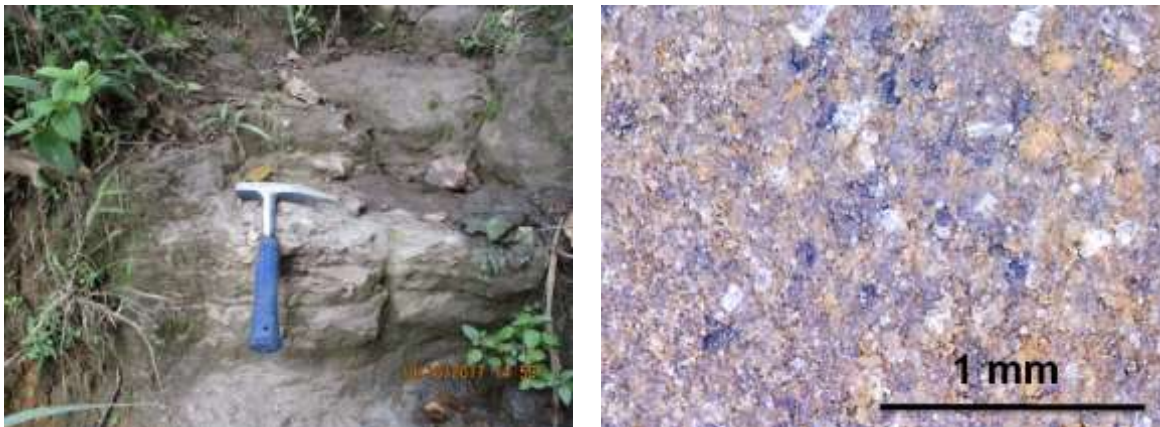
Fotografía 3.7 Cuarzoarenita de la Formación Tablazo. Fotografía microscópica tomada con Celestron Handheld Digital Microscope PRO - 200X
