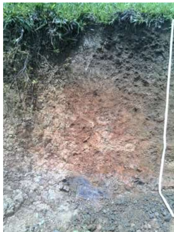
Fotografía 3.38 Unidad MQFdp. Suelo Typic Dystrudepts, francosa, isotérmica (Perfil HMV 5. Coordenada Magna origen Bogotá E:1085456 – N: 1183437)
