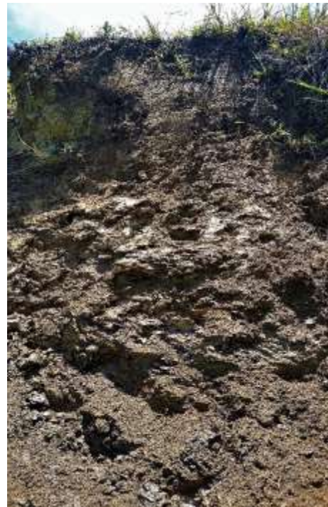
Fotografía 3.30 Unidad MQCd. Suelo Lithic Udorthents, franca fina, isotérmica (Perfil HMV 1 Coordenada Magna Bogotá E:1078852 - N:1188209)
