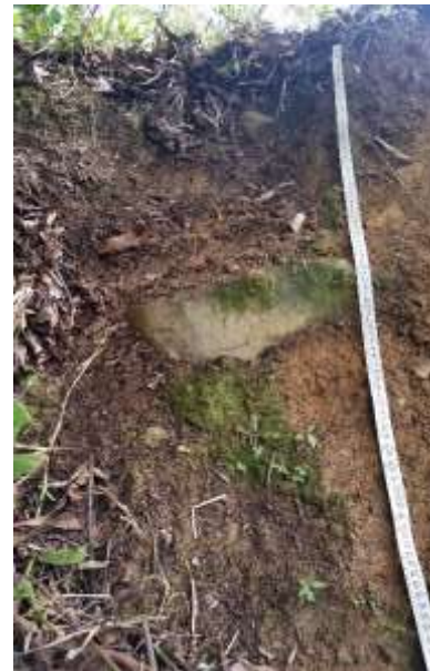
Fotografía 3.46 Unidad LQCd. Suelo Typic Dystrudepts, franca fina, isotérmica (Calicata HMV 4 Coordenada Magna Bogotá E:1079559 - N:1185926)
